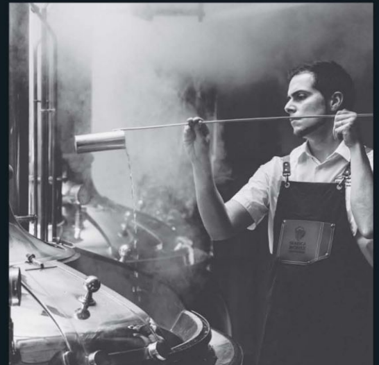
En la fase de cocción se añade el lúpulo que aportará aroma y amargor.
